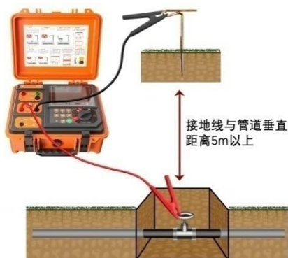
图 5- 3 金属管道直连法接线图
