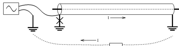
图 5- 7 护层-大地接法信号流向示意图
