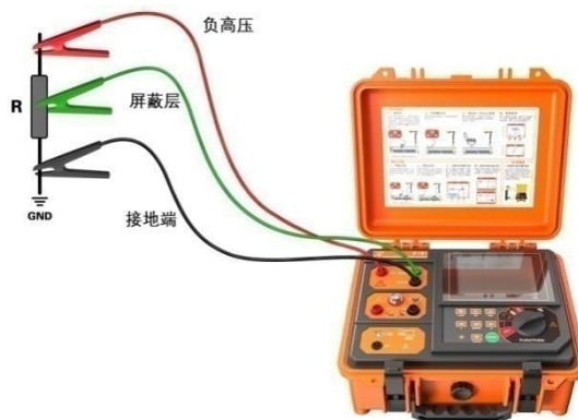
图 8- 8 绝缘电阻测量接线（带屏蔽）
