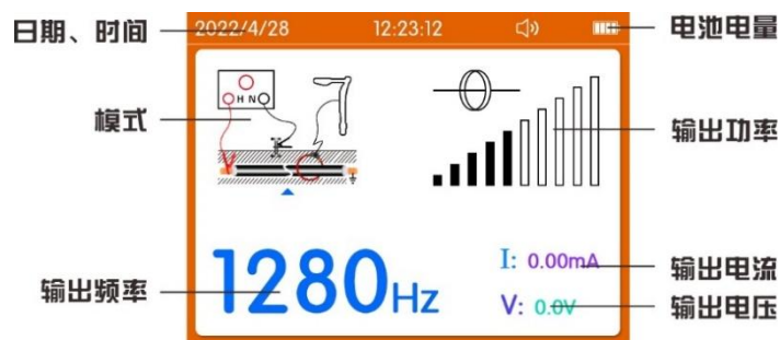
图 5- 2 电缆识别模式直连法输出界面图
