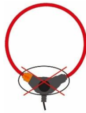
图 6- 19 易对柔性线圈产生干扰区域
