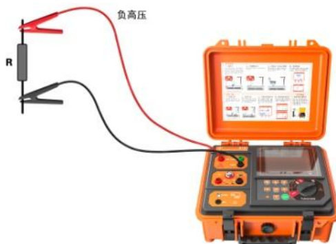
图 8- 7 绝缘电阻测量接线（无屏蔽）
